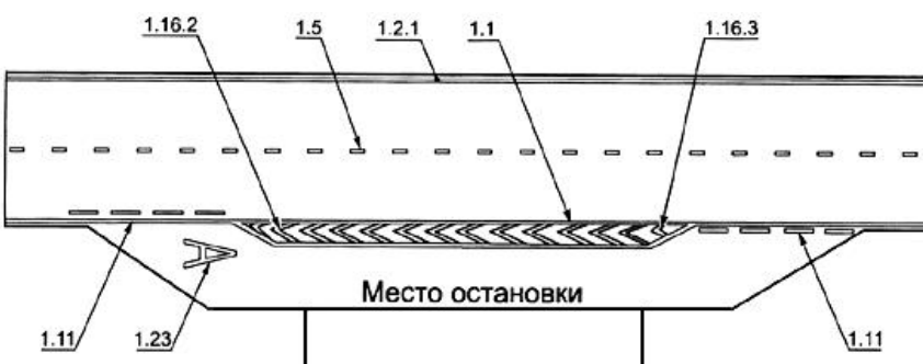
Рисунок В.14 - Пример нанесения разметки в местах остановки маршрутных транспортных средств
